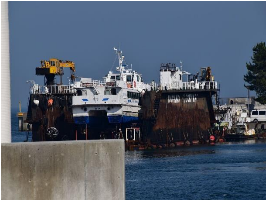
夕刻には、浮ドック内に入り、修理のようでした。
